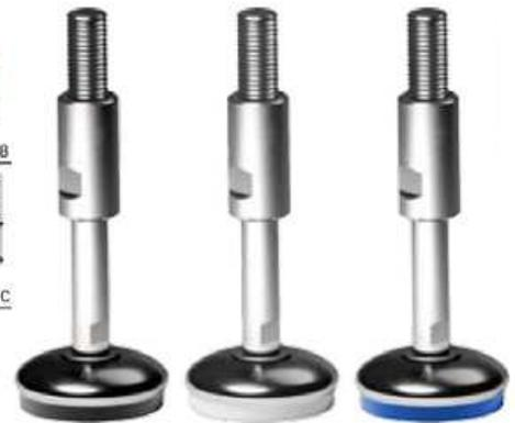
**Material der Fußplatte:** aus Polyamid, glasfaserverstärkt; Überzug aus Edelstahl AISI 304; Anti-rutsch-platte aus thermoplastischem Kautschuk 68 shore, schwarz, weiß oder blau Ral 5005.
