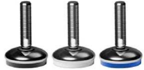
**Material der Fußplatte:** aus Polyamid, glasfaserverstärkt; Überzug aus Edelstahl AISI 304; Anti-rutsch-platte aus thermoplastischem Kautschuk 68 shore, schwarz, weiß oder blau Ral 5005.
