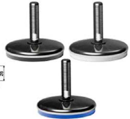
**Material der Fußplatte:** aus Polyamid, glasfaserverstärkt; Überzug aus Edelstahl AISI 304; Anti-rutsch-platte aus thermoplastischem Kautschuk 68 shore, schwarz, weiß oder blau Ral 5005.
